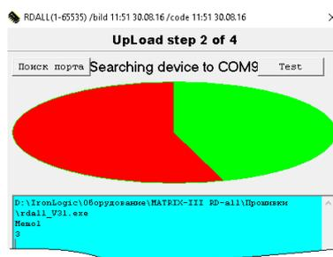
Если питание на считыватель было подано, то нужно снять и снова подать питание. После поиска устройств, подключенных к конвертеру, появится шкала прошивки.
