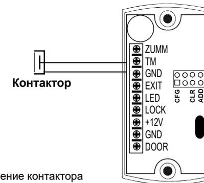
Рис.6 Подключение контактора
