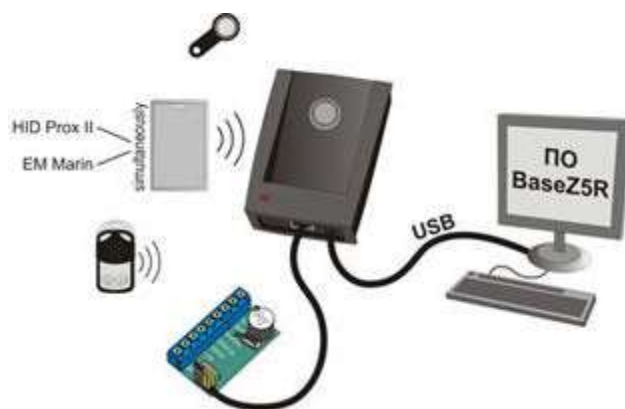
8. Схема подключения адаптера Z-2 (мод. E HTZ RF) к контроллеру и компьютеру
